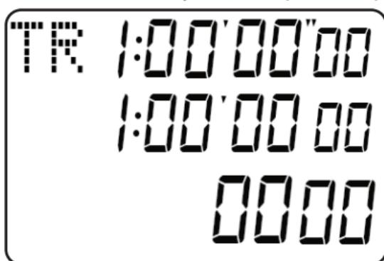
При нажатии на кнопку (2), прибор перейдёт в режиме обратного отсчета времени. В первой строке отображается заданное время обратного отсчета, а во второй строке – текущее время обратного отсчета, в третьей строке - количество циклов обратного отсчета.
