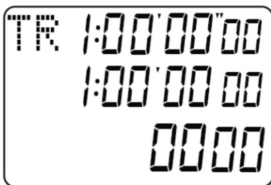
Нажмите кнопку (1), чтобы установить время отсчета в часах. Последовательным нажатием кнопки (2) выберете время отсчета таймера - от 0 до 9 часов. Повторно нажмите кнопку (1). С помощью кнопки (2) установите время отсчета таймера - от 0 до 59 минут. Удерживайте кнопку (2) для быстрого изменения значения минут. Повторите последовательность из кнопок (1) и (2) для установки времени отсчета таймера в секундах. Нажмите кнопку (1) для сохранения времени таймера.
